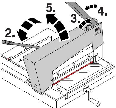
**D** Der Messerhebel (A) darf nicht selbstständig nach unten fallen. Gegebenenfalls Sechskantmutter nachziehen. Abdeckhaube (K) entfernen: Die 2 Schrauben (P) der Abdeckhaube herausdrehen (1.). Pressung schließen (2.). Messerarretierung lösen (3.) Messerhebel etwas nach links stellen (4.), dann Abdeckhaube (5.) abnehmen.
