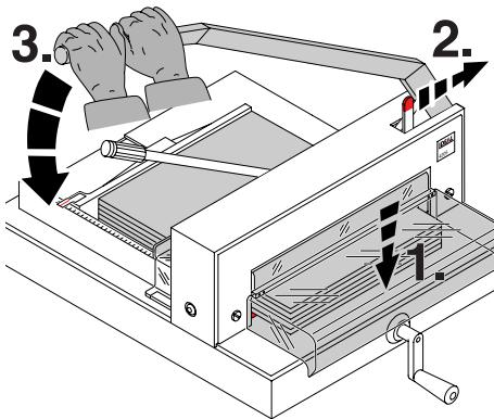
**D** Haube vorne schließen (1.). Messerarretierung lösen (2.). Messerhebel mit **beiden Händen** nach unten führen (3.)
