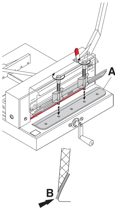
**D** Austauschmesser vorsichtig aus Messerkasten nehmen und mit Messerwechselseinheit verschrauben! **(A)**.
