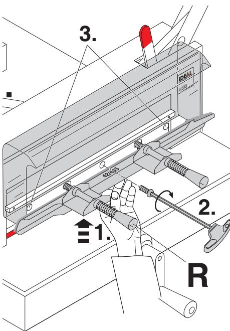
**D** Mit der einen Hand die Messerwechselvorrichtung nach oben drücken (1.). Mit der anderen Hand die mittlere Messerschraube zuerst leicht festschrauben (2.), danach die beiden Messerschrauben links und rechts leicht festschrauben (3.)
