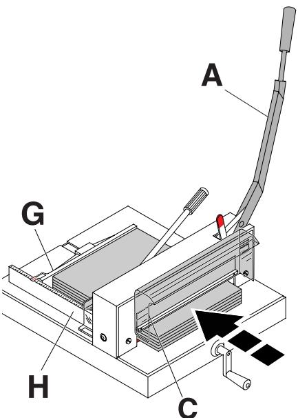
**D** Der Messerhebel (**A**) steht **arriertet** in der oberen Ausgangsposition, Haube vorne (**C**) nach oben klappen, Papierstapel von vorne in die Maschine einschieben und hinten am Rückanschlag (**G**) und links am Seitenanschlag (**H**) exakt anlegen.
