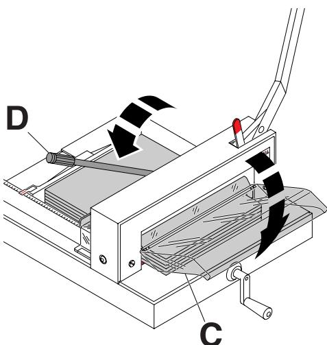
**D** Handgriff für Papierpressung (**D**) vor jedem Schnitt nach links umlegen und mit einem leichten Ruck arretieren. Haube vorne (**C**) schließen.
