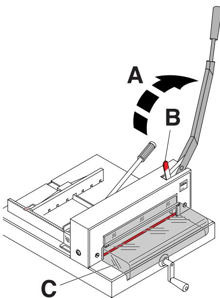
**D** Messerhebel (**A**) nach jedem Schneidvorgang so weit zurückstellen, bis die Messerarretierung (**B**) **eintrastet**. Die Messerarretierung sichert das Messer in der obersten Ausgangsposition. Der Schneidvorgang kann nur ausgeführt werden, wenn die Haube vorne (**C**) nach unten geklappt und die Arretierung (**B**) gelöst ist.
