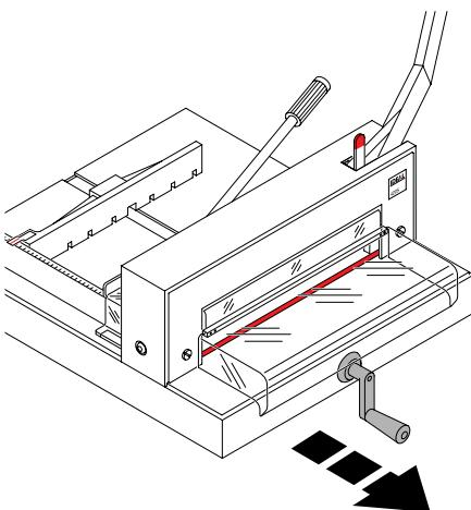
**D** Versehentliche Maßverstellung wird vermieden, durch Vorziehen der Handkurbel.
