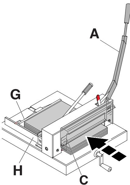
**I** La leva di taglio (**A**) é **arretrata** all punto di partenza, alzare lo schermo di sicurezza (**C**). Posizionare essattamente le pile di carta sul margine posteriore (**G**) e sul margine laterale (**H**).
