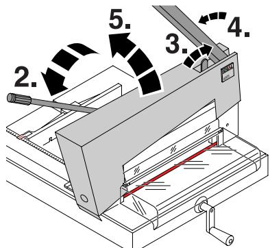
**NL** Het meshendel (**A**) mag nooit uit zichzelf naar beneden vallen. Wanneer nodig de zeskantmoer vastdraaien verwijder de bovenkap (**K**) verwijder de 2 schroeven (**P**) van de bovenkap (1.). Sluit de klem (2.). Mesblokkering losmaken (3.) en beweeg de meshendel (4.) een klein stukje naar links, verwijder de bovenkap (5.).
